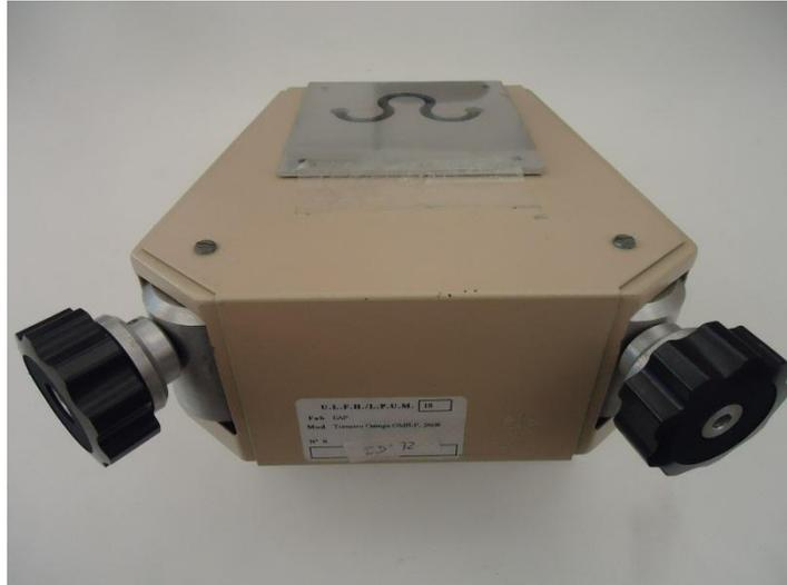
Figura 21 – Base de suporte do teste de OMEGA.
