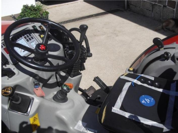
Figura 7 - Localização e fixação do acelerómetro tri-axial no assento de um trator.
