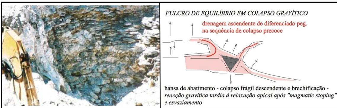
**Figura 42** – Corta Sul no grupo pegmatítico de S.ª de Assunção, Sátão – *sinkhole* de colapso gravítico por esvaziamento – com brecha de clastos horizontalmente alongados (essencialmente quartzosos) e matriz de caulinite + haloizite + mica e relíquias de columbite-tantalite + zircão (após caulinização dos feldspatos).
