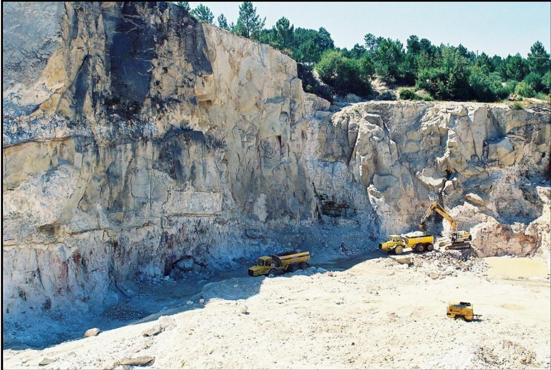
**Figura 59** – Bandas pegmatíticas no talude principal do corpo sul da mina de Senhora de Assunção. Junto aos *dumpers* nota-se uma chaminé com propagação de estruturas de colapso em profundidade.
