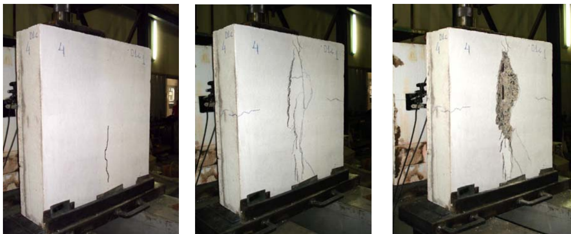
Figura 9 – Fissuração progressiva típica para o CR56b-PL.
