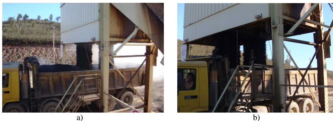
Figura 2: Diferença nas emissões de fumos e gases observados na central durante a descarga das misturas betuminosas para o camião: a) MBQ (150 a 160°C); b) MBT (120 a 140°C)
