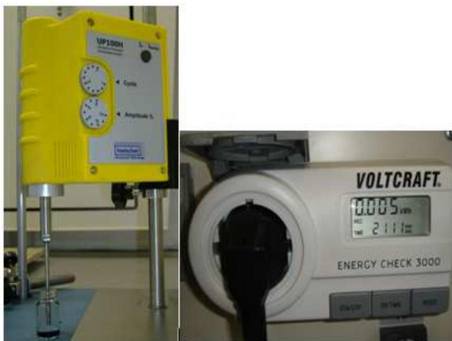
**Figura 10:** Equipamento de Ultra-Sons utilizado. Ponta de ultra-sons UP100H (esquerda); Aparelho electrónico acoplado (direita)
