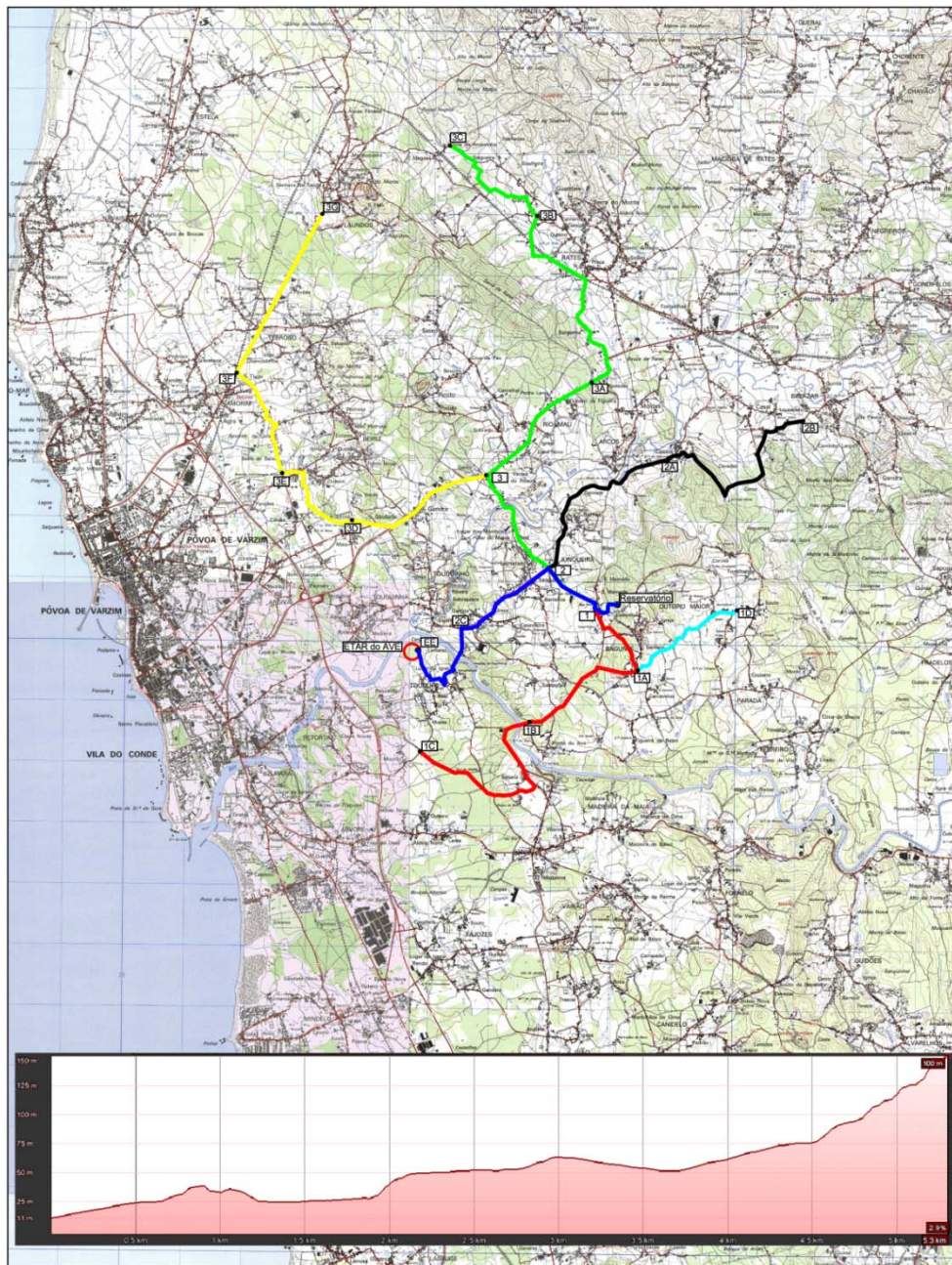
Figura 6.2 – Implantação do trajecto da rede de abastecimento e perfil longitudinal da Condução Elevatória
