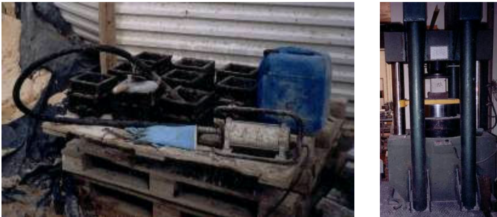
Figura 1: Vibrador, moldes e equipamento para o ensaio de compressão
