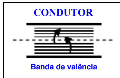
Fig. 1.3 – Diagrama esquemático da banda de energia de um condutor metálico
