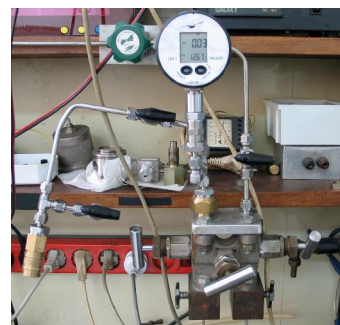
Sl.3. Merna metoda. Pritisak je meren manometrom firme Keller sa opsegom merenja do 200 bar.
