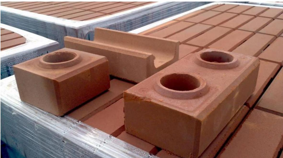
*Nota:* se observa ladrillos de construcción que no necesitan ser horneados, reduciendo el consumo energético y su costo final (<https://bit.ly/3HZNLhy>)
