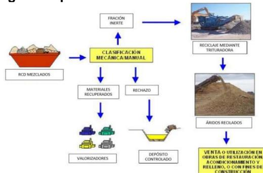
Figura 7. Procesos del tratamiento de los RCD en una planta de valoración. Fuente: Generalitat Valenciana 2008
