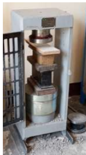
Figura 73. Posición de rotura a compresión de adobe Fuente: Propia
