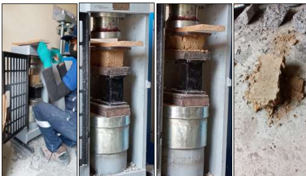
Figura 85. Proceso de rotura a compresión de adobe Fuente: Propia
