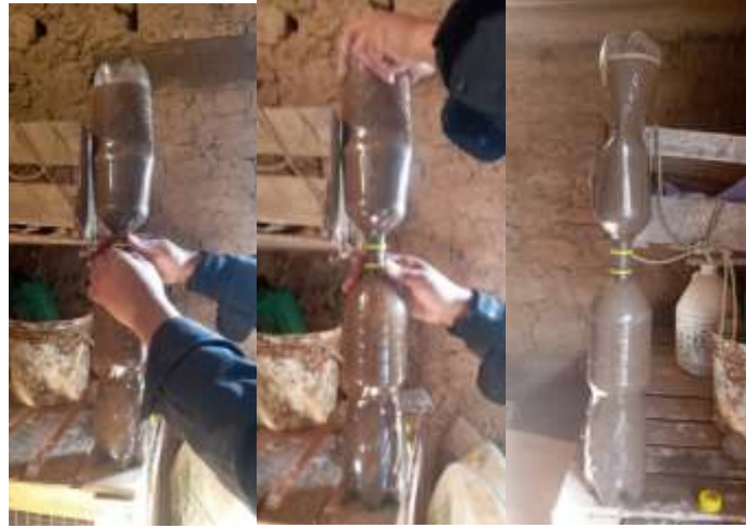
Figura 43. Separación del suelo Fuente: Propia
