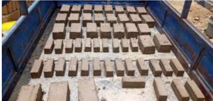
Figura 56. Proceso de secado del adobe Fuente: Propia
