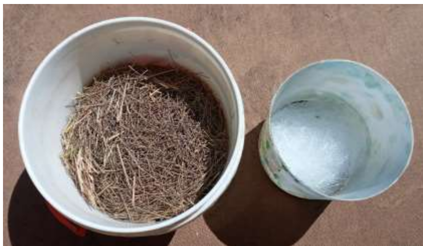
Figura 51. Fibras acondicionadas para el uso del adobe Fuente: Propia
