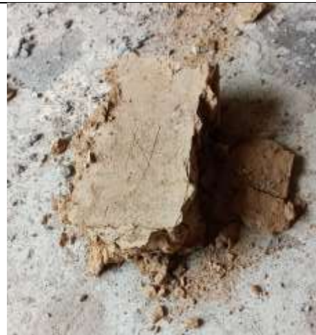
Fotografía 33. Resultado de muestra comprimida.
