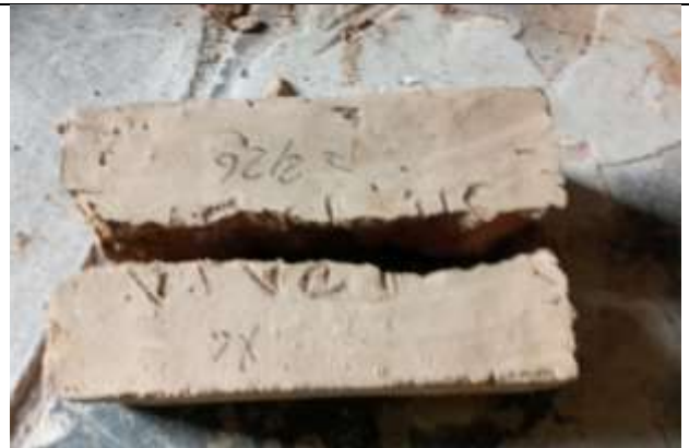
Fotografía 45. Resultado de muestra a tracción
