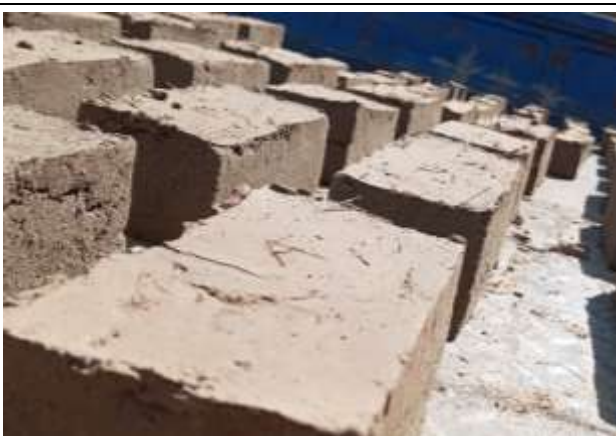
Fotografía 16. Muestra secada después de 72 horas.
