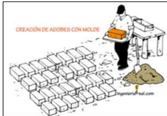
Figura 22. Creación de adobe con molde. Fuente: Ingeniería Real
