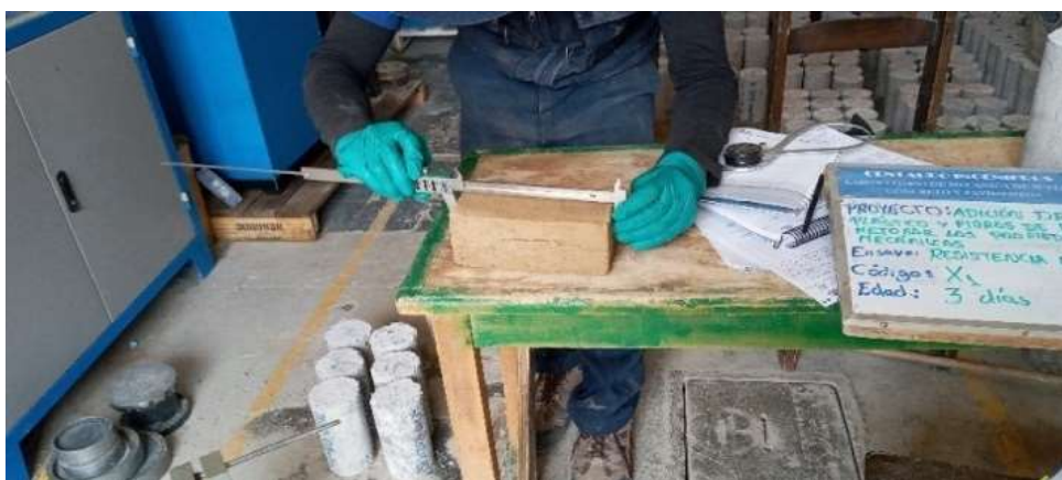
Figura 80. Medición de las dimensiones del adobe Fuente: Propia
