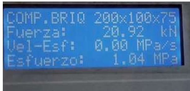
Figura 74. Registro digital de ensayo de compresión Fuente: Propia
