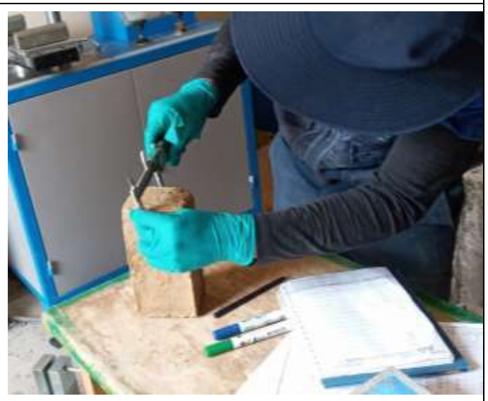
Fotografía 25. Medición de la muestra (espesor).
