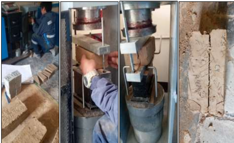
Figura 92. Proceso de rotura a tracción de adobe Fuente: Propia
