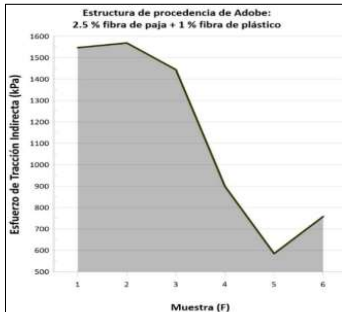
Figura 88. Gráfico de resistencia a tracción de muestra (F) Fuente: Propia
