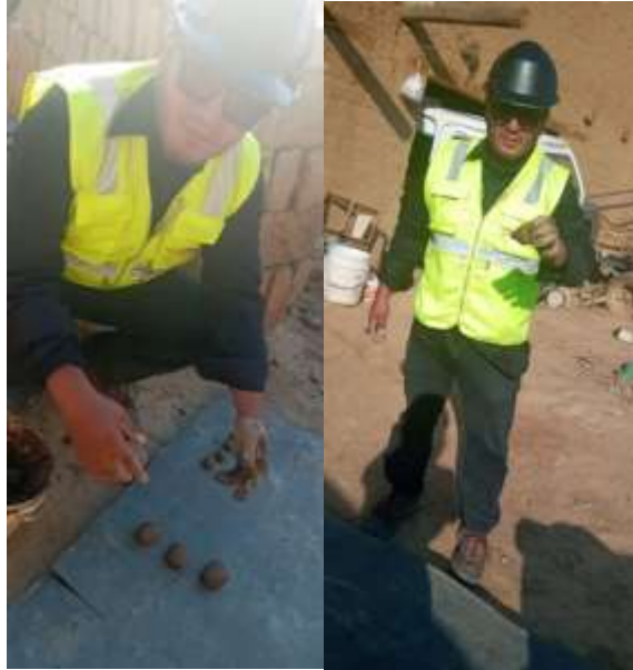
Figura 38. Caída libre de bolas de barro en estado fresco Fuente: Propia
