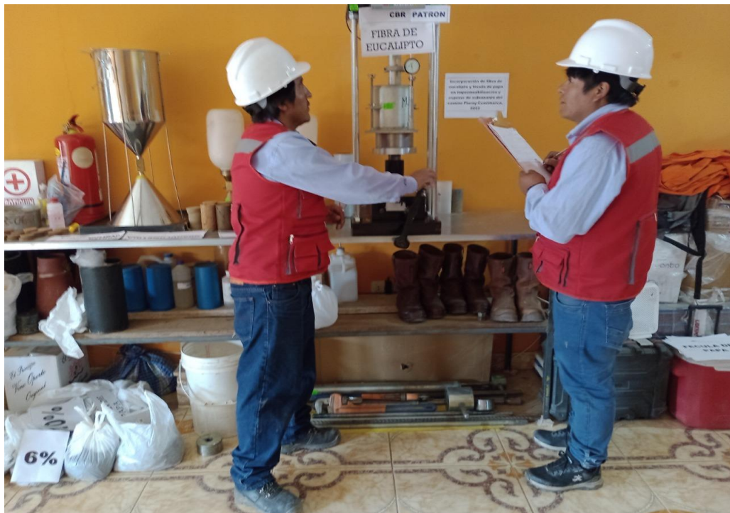
Ensayo de CBR
