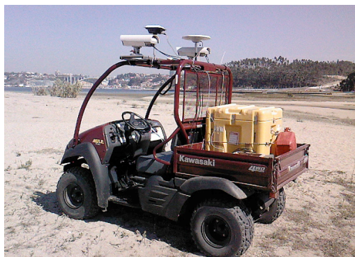
Figura 1 – Sistema móvel equipado com duas antenas cinemáticas, equipamento de videogrametria e data logger , e exemplo de uma rede de levantamentos (esquerda) para uma secção da área monitorizada (Aguda)
