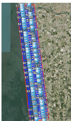
Figura 2 - Plano de voo com as duas fiadas de fotografias aéreas sobrepostas (cerca de 100)
