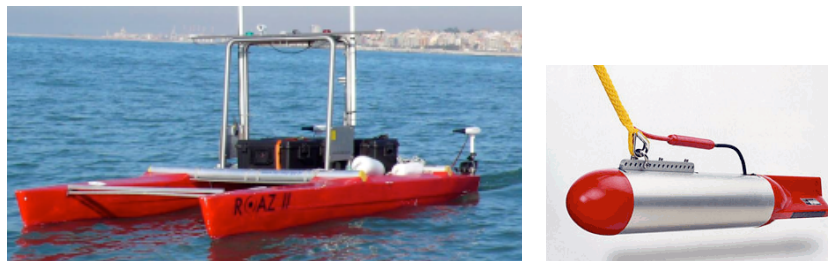
Figura 3 – Catamarã equipado e sonar de varrimento lateral
