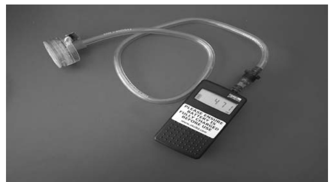
Figura 1 – Dispositivo utilizado para monitorizar a nicotina no ar (bomba de vácuo e monitor).
