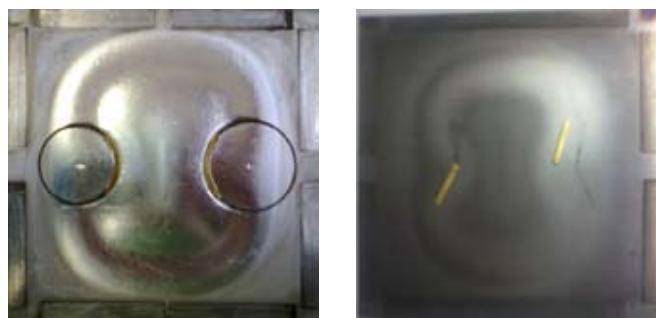
Fig. 1. a) imagem do alvo de alumínio com duas inserções de Au perto da zona de erosão do alvo e b) imagem do alvo de tungsténio com duas tiras de ouro coladas junto à zona de erosão do alvo.
