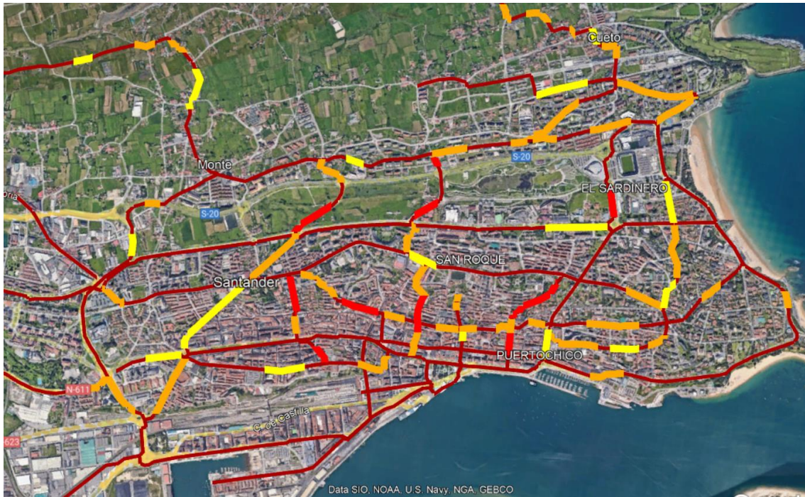
Ilustración 4: Red ciclista propuesta en las fases iniciales de este proyecto. En amarillo se destacan las rampas con pendiente media de entre un 3% y un 5%, en naranja entre un 5% y un 10% y, en rojo, superior a un 10%. Fuente: elaboración propia a partir de Google Earth.
