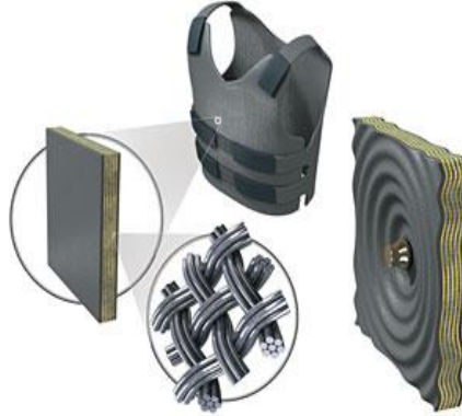
Figura 3 - Funcionamento do colete à prova de bala (Imagem retirada de http://gmc.carlinhossilva.blogspot.com/2011/04/especial-armas-de-fogo-o-colete.html ).
