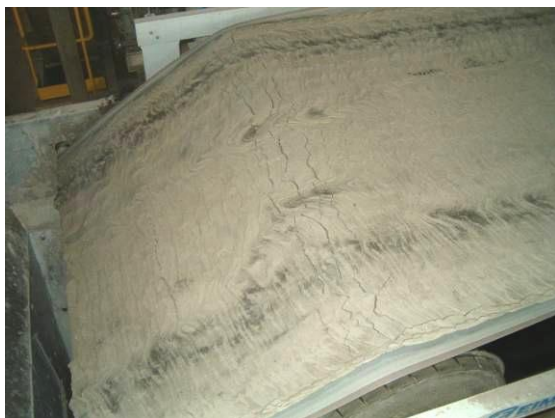
Fig. 1 – Gesso FGD na central térmica
