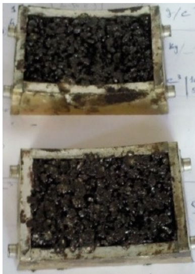
Figura 3. Amostra do pavimento asfáltico confeccionado.
