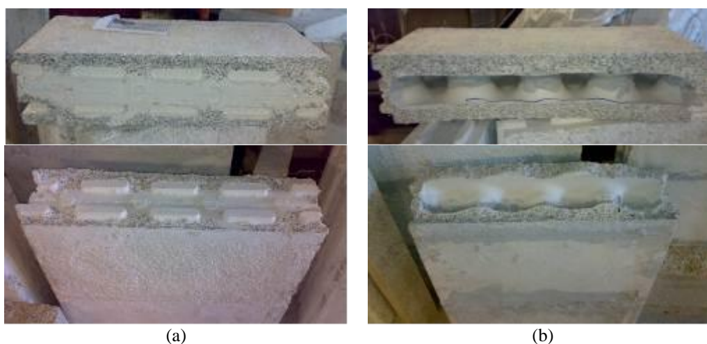
Figura 12 : Modos de rotura em flexão; (a) provetes construídos com a pasta adesiva PA1; (b) provetes construídos com a pasta adesiva PA2
