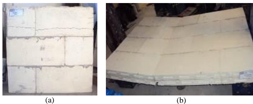
Figura 16 : Modos de rotura em flexão; (a) direção paralela às juntas horizontais; (b) direção perpendicular às juntas horizontais
