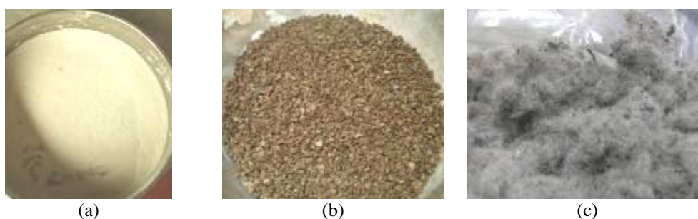
Figura 5 : Materiais constituintes do material compósito; (a) gesso FGD; (b) regranulado de cortiça; (c) fibras têxteis
