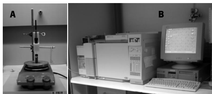
Figura 2.1. Ilustração do equipamento para SPME (A) e de GC/MS (B) utilizados.
