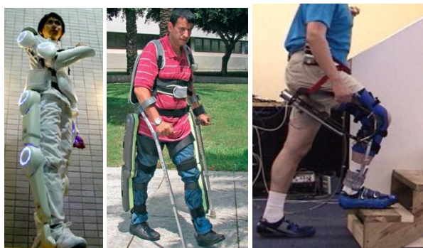
Fig. 6 Na imagem da esquerda: Dispositivo HAL comercializado pela Cyberdyne Tsukuba (24). Na imagem do centro encontra-se o dispositivo ReWalk™ (25). Na imagem da direita encontra-se o protótipo da ortótese RoboWalker desenvolvido pela Yobotics (26).
