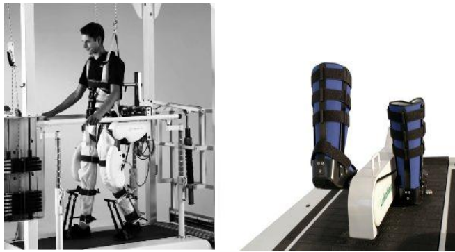
Fig. 2 À direita: Ortótese robótica Lokomat em utilização (8). À esquerda: Dispositivo LokoHelp(9)
