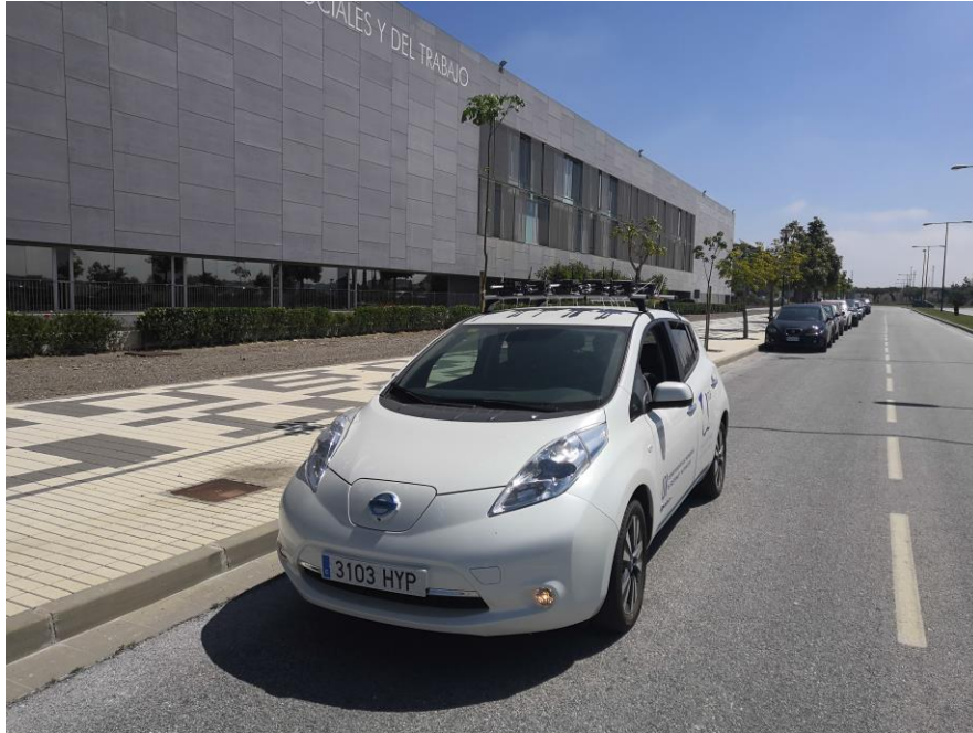
Figura 5.5 Nissan Leaf con los nodos sensores en su baca.
