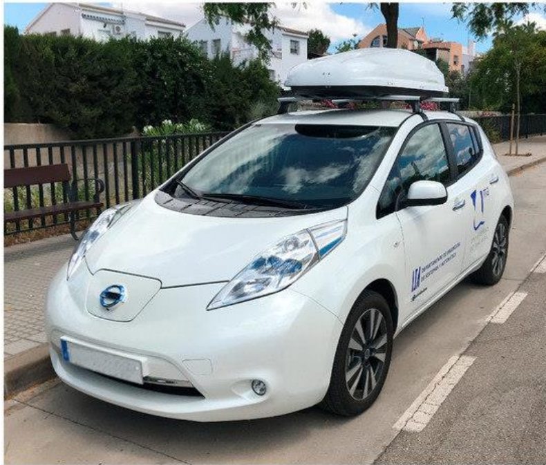
Figura 5.1 Vehículo utilizado en experimentos. Se muestra el contenedor empleado para portar los elementos del nodo móvil.
