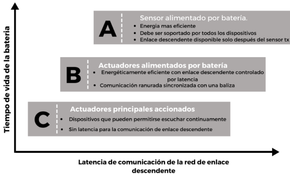
Figura 4.4. Relación entre la latencia y la duración de la batería para las diferentes clases de nodos (adaptada de [111]).
