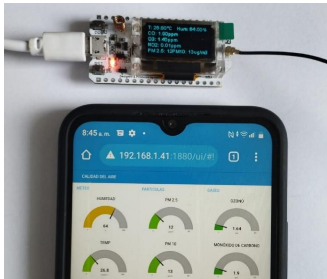
Figura 51. Prueba de conexión entre la Puerta de enlace y el concentrador
