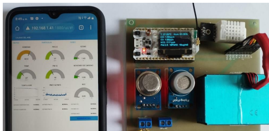
Figura 52. Prueba de visualización de datos de la MOTA
