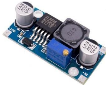
Figura 14. Módulo elevador de voltaje XI6009
