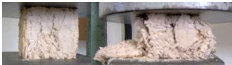
Figura 7 – Comportamento à compressão do composto de cânhamo - a) durante a rotura inicial e b) após a rotura.
