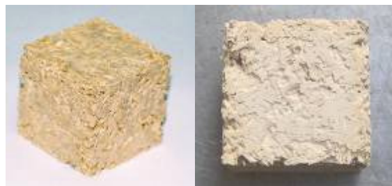
Figura 4 – Amostras do compósito de cânhamo antes e depois da cura, a) e b) respectivamente.
