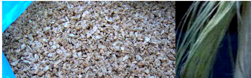
Figura 2 – Materiais para placas compósitas - a) granulado de cortiça e b) fibras de cânhamo.
