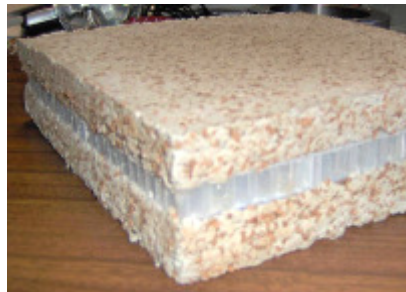
Figura 13 – Placa sanduíche de pasta de papel/cortiça e favo de abelha PP.
