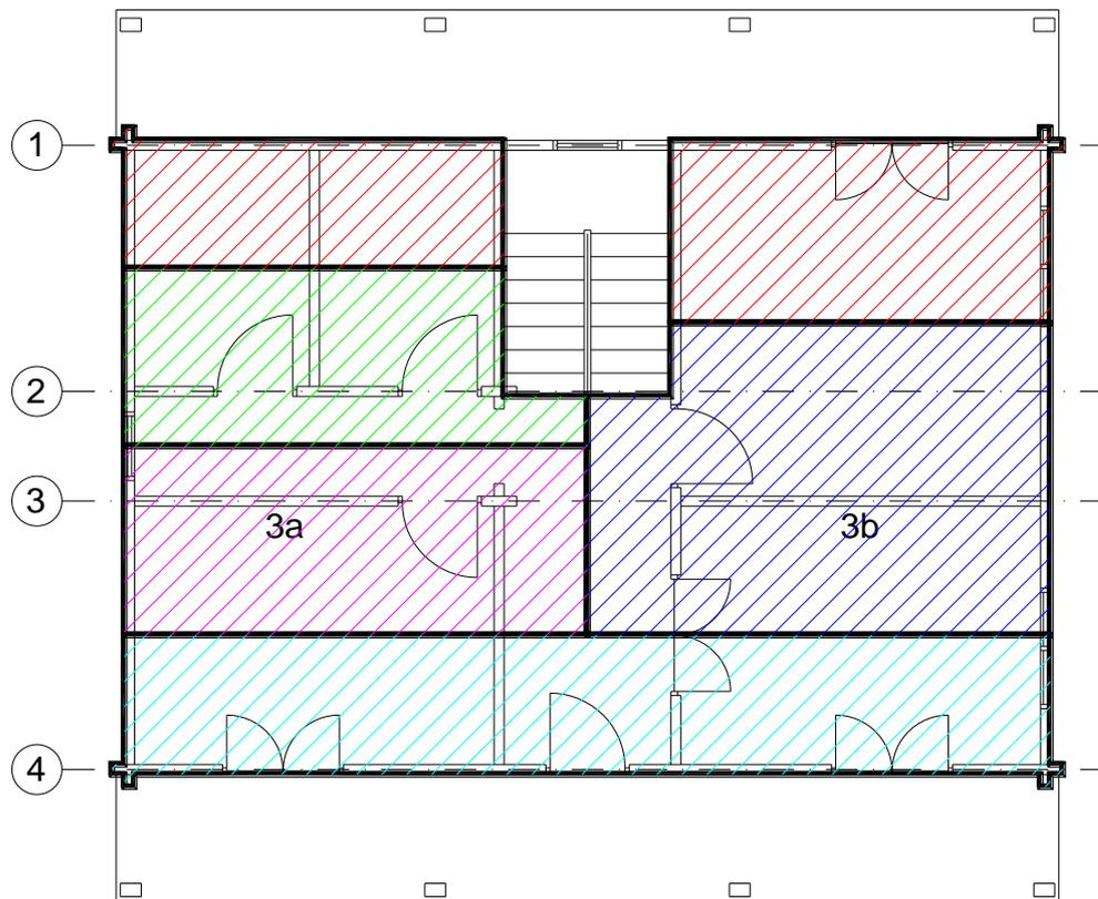
**Figura 34** – Áreas de influência das paredes do rés-do-chão, segundo a direcção X
