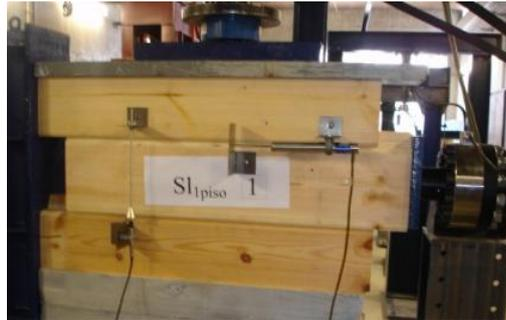
**Figura 9** – Fotografia dos ensaios com provetes de 3 toros e instrumentação utilizada
