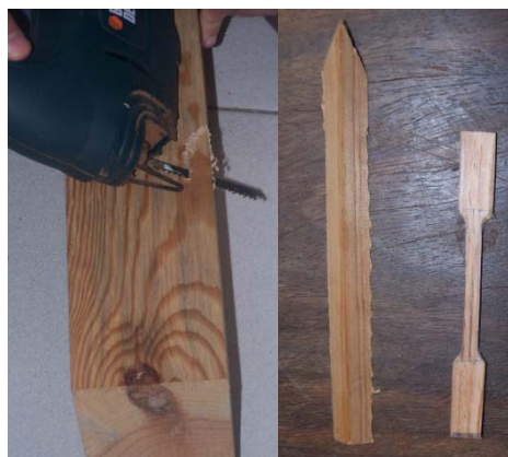
Fig. 2 – Método proposto para obtenção dos mesoprovetes: à esquerda, corte da peça principal; à direita, transformação para provete similar ao utilizado em ensaio de materiais plásticos
