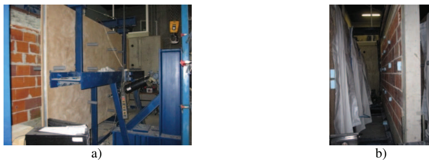
Figura 7 – Infra-estrutura de ensaio: a) Painel de transmissão de carga; b) Airbags
