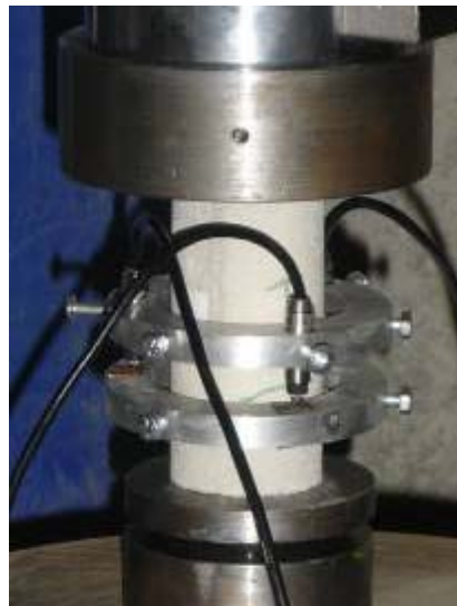
Figura 9: Esquema do ensaio para a determinação do módulo de elasticidade da argamassa.
