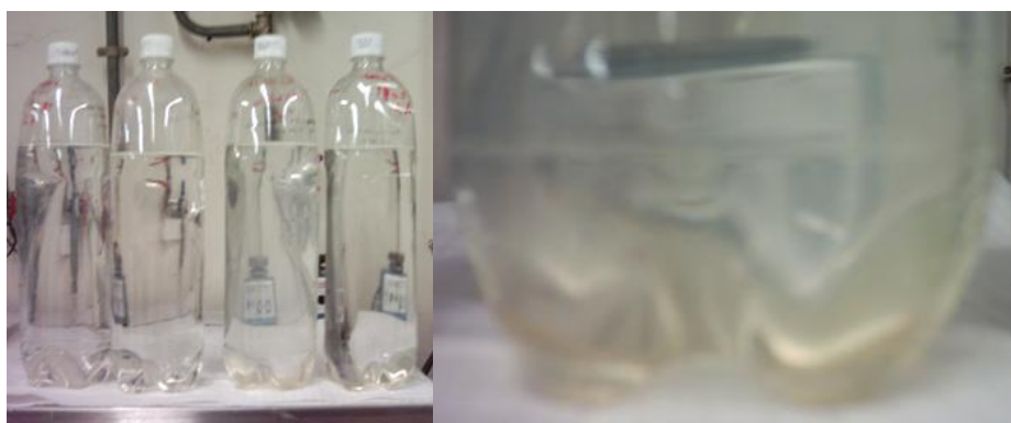
Figura 5. Ensaio de oxidação solar e pormenor do resíduo retido após um ensaio
