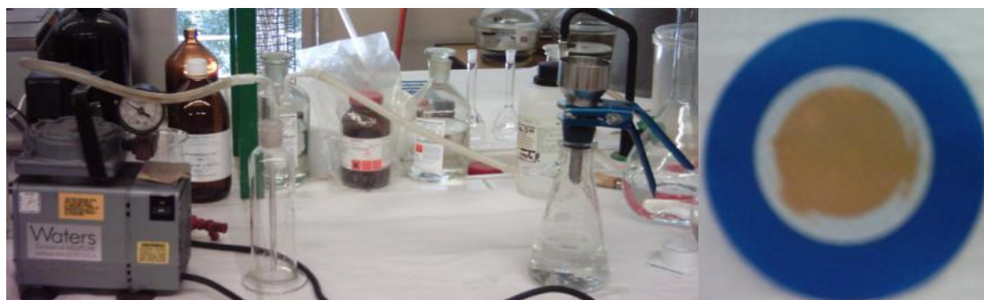
Figura 3. Processo de filtração prévia e aspecto final do filtro utilizado
