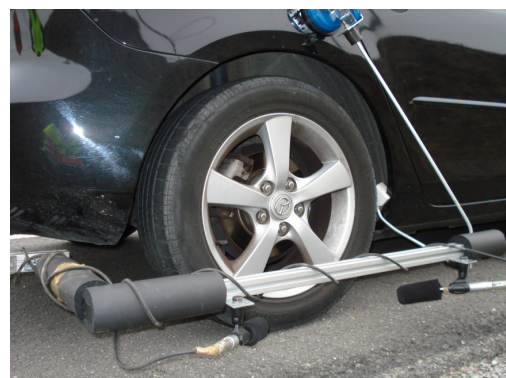
Figura 1: Aspecto da realização dos ensaios SPB (à esquerda) e pormenor do equipamento para ensaios CPX (à direita)
