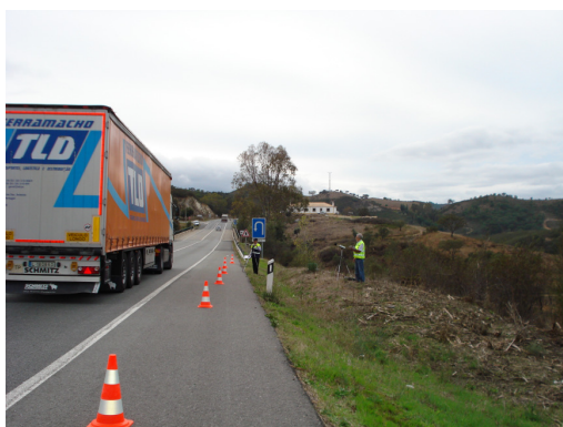
Figura 1: Aspecto da realização dos ensaios SPB (à esquerda) e pormenor do equipamento para ensaios CPX (à direita)
