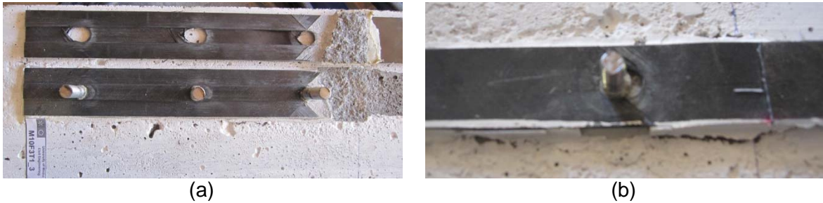
Figura 21 – Modos de rotura típicos obtidos na série MF-EBR com três ancoragens: (a) delaminação do MDL para o provete M10F3S2T1_3; (b) esmagamento do laminado ao nível das ancoragens para o provete M8F3S2T1_2.
