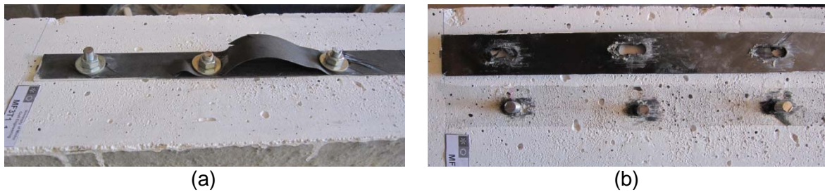
Figura 27 – Modos de rotura típicos obtidos na série MF-FRP com três ancoragens: (a) delaminação do MDL para o provete M8F3T1_1; (b) esmagamento do laminado ao nível das ancoragens para o provete M8F3T1_1.
