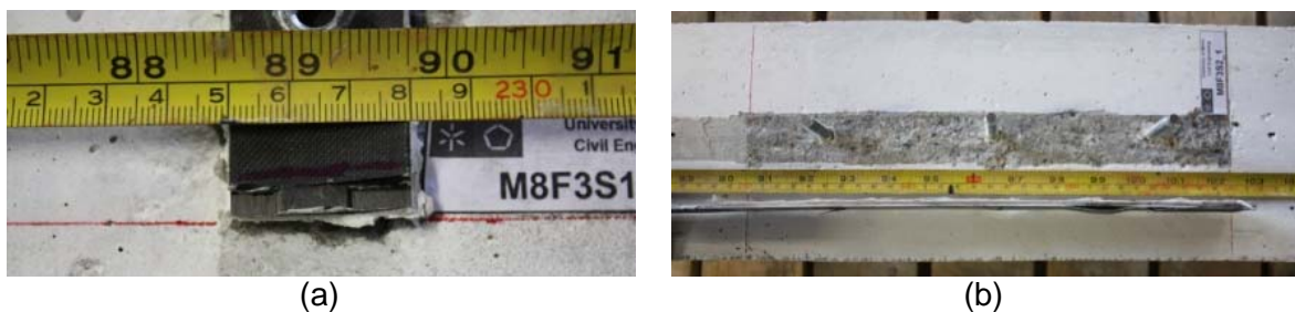
Figura 13 – Fotos: (a) largura da cunha no provete M8F3S1T0_1; (b) comprimento de amarração do provete M8F3S2T0_1.
