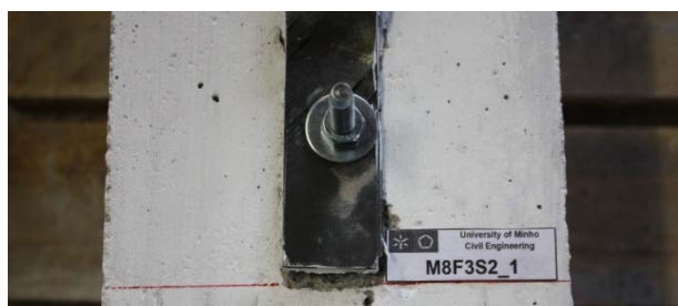
Figura 9 – Pormenor da execução de reforço para o sistema de aplicação S2 no provete M8F3S2T0_1.
