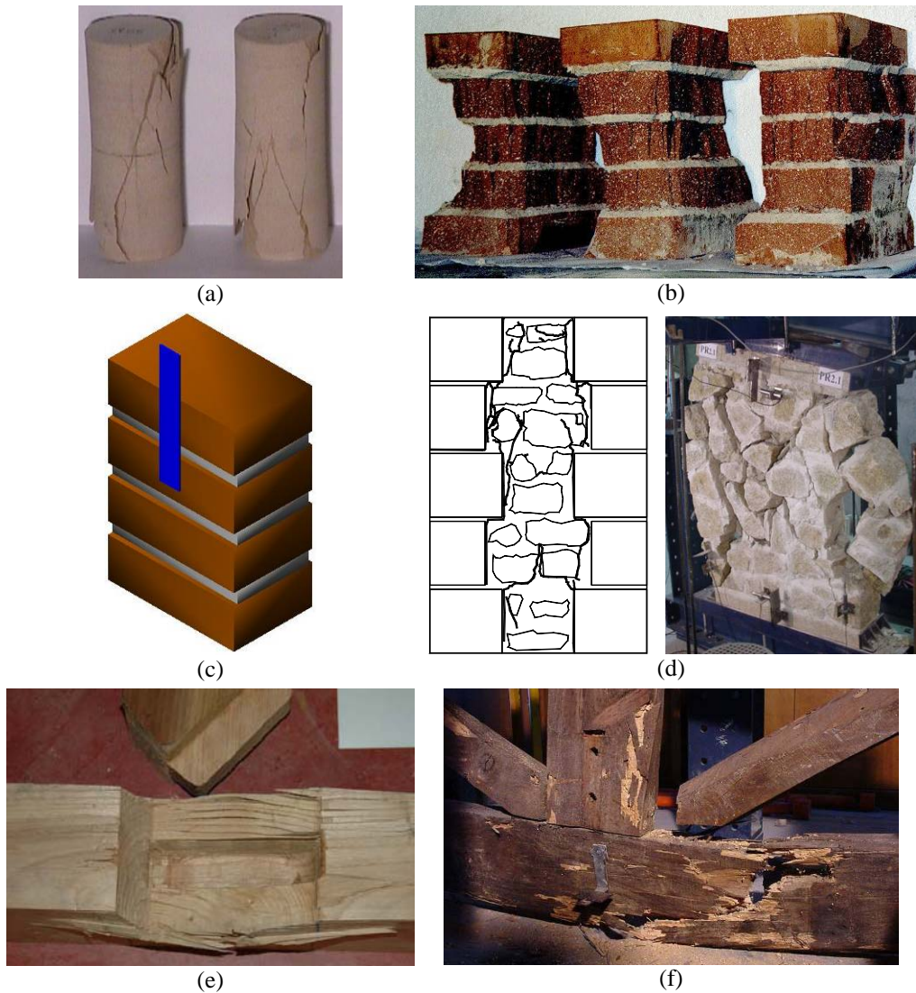
Figure 2: Exemples de caractérisation expérimentale et ruine de structures anciennes dans l'Université du Minho: (a) pierre soumise à compression uni-axiale; (b) maçonnerie soumise à compression uni-axiale; (c) arrachement en maçonnerie renforcée avec FRP; (d) parois composée de pierre en compression et parois soumise au cisaillement; (e) liaison traditionnelle en chêne; (f) poutres en bois ancien.
