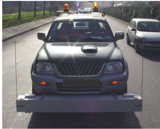
Figura 3 – Equipamento usado para a medição do IRI e da MPD
