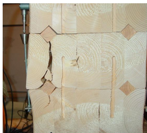
Figura 6 – Modo de rotura típico observado nos ensaios de compressão perpendicular às fibras
