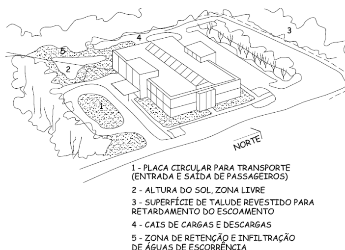
Figura 8.1.: Representação esquemática de uma implantação típica de uma construção em climas temperados 397 .
