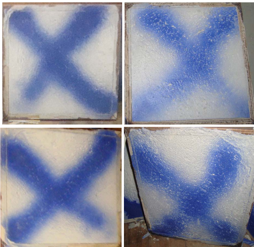
Figura 4 – Provetes de argamassa de cimento com diferentes texturas: a) com 2% de \text{TiO}_2 e superfície lisa; b) com 2% de \text{TiO}_2 e superfície rugosa; c) com 5% de \text{TiO}_2 e superfície lisa; d) com 5% de \text{TiO}_2 e superfície rugosa
