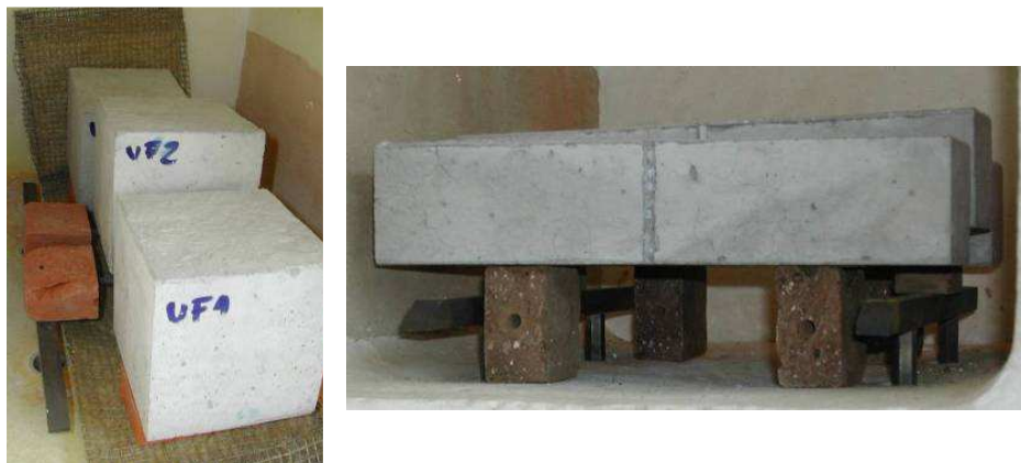
Figura 17 – Disposição dos provetes no interior do equipamento
