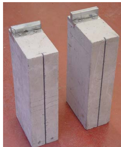
Figura 28 – Aspecto final dos provetes após a realização das ranhuras.
