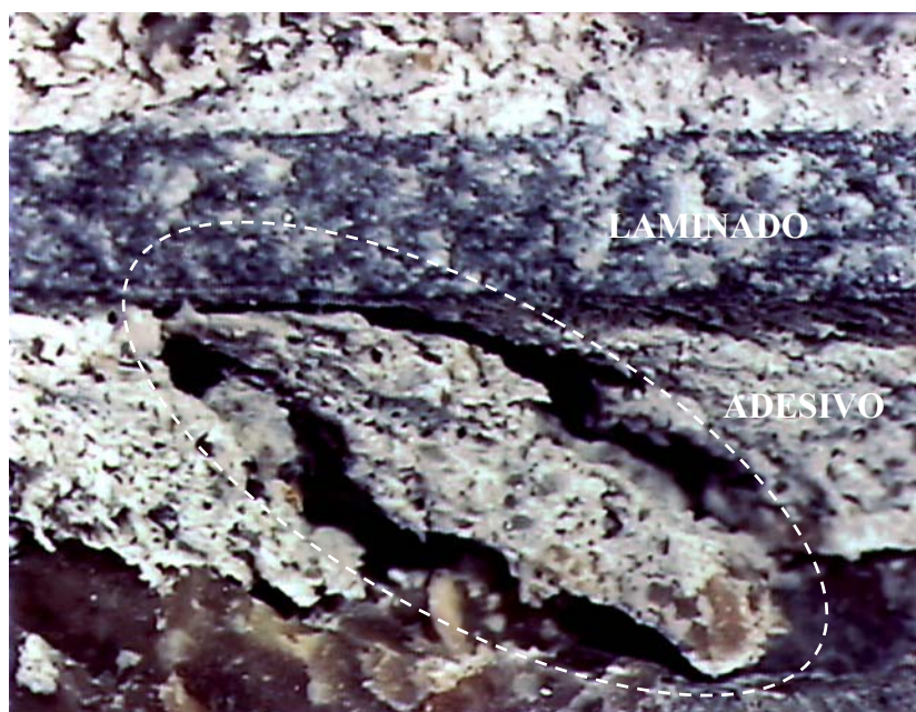
Figura 35 - Rotura de uma biela de adesivo.
