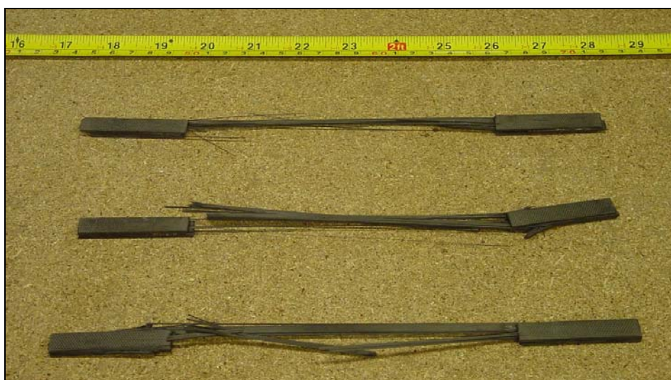
Figura 22 – Aspecto final dos provetes após terem sido ensaiados.
