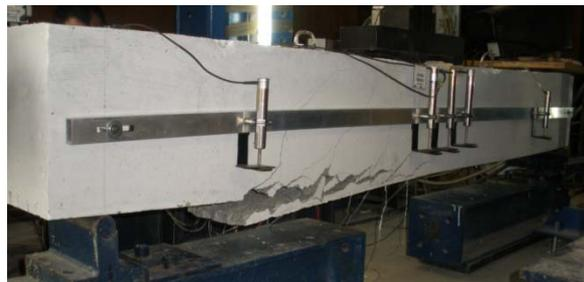
Figura 7. Modo de rotura do laminado CFK na viga NSM.
