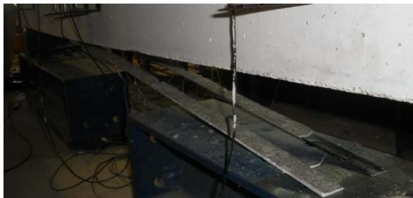
Figura 6. Modo de rotura do laminado CFK na viga EBR.
