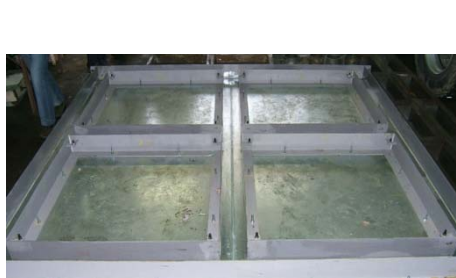
Fig. 5. Protótipo de grelha de fundação (dimensões em mm).
