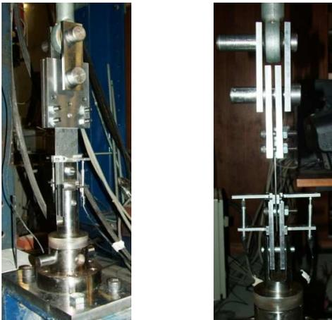
Fig. 13 – Configuração adoptada para os ensaios de resistência ao esmagamento.
