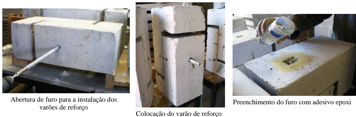
Figura 4. Aplicação do reforço segundo à técnica CDM.
