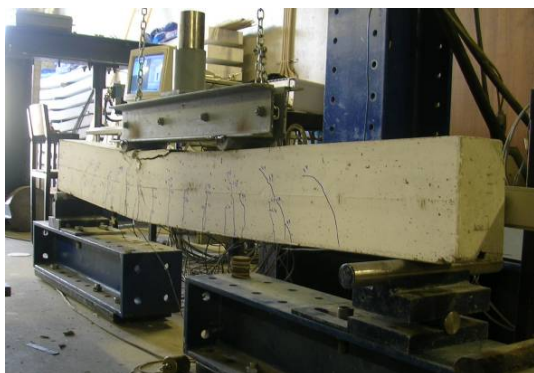
Figura 10. Modo de rotura da viga VLP.
