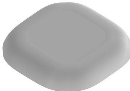
Figura 2 – Módulo de aligeiramento para a configuração de painel proposta no âmbito do presente trabalho.
