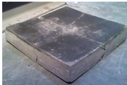
Figura 17 – Padrão de fendilhação obtido no ensaio experimental.
