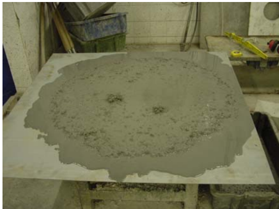
Figura 11. Amostra de betão depois de espalhada com o cone de Abrams.
