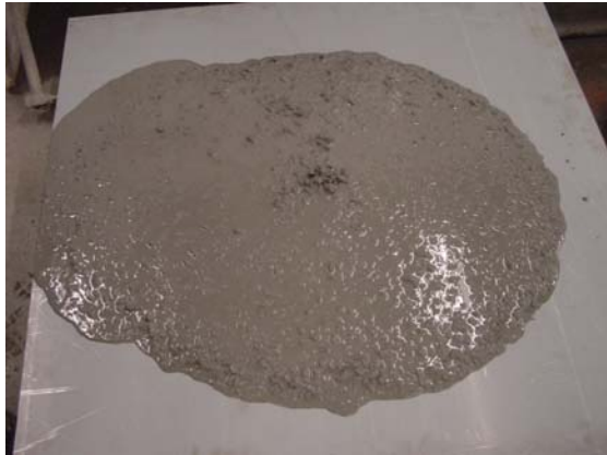
Figura 13. Amostra de betão depois de espalhada com o cone de Abrams.
