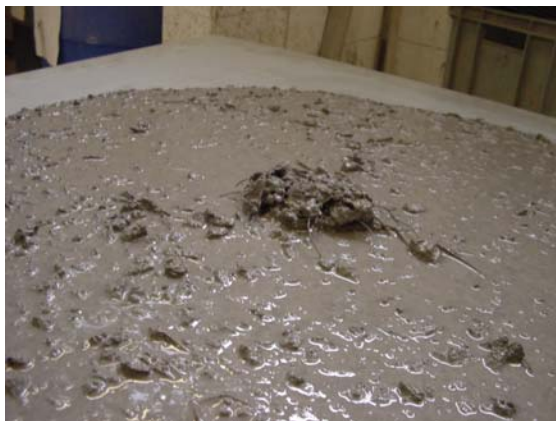
Figura 15. Amostra de betão depois de espalhada com o cone de Abrams.
