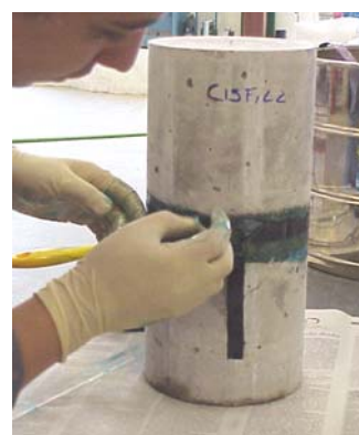
Figura 7 – Aplicação das faixas de manta.
