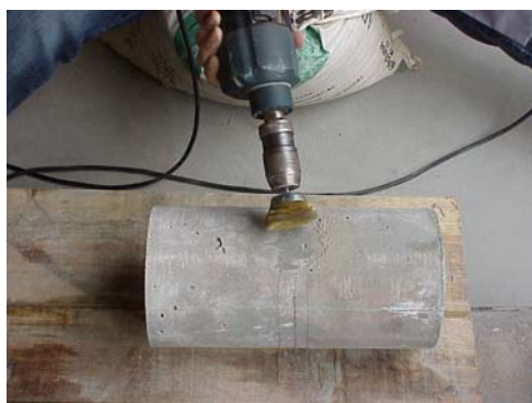
Figura 3 – Esmerilamento do provete nas zonas de fixação das faixas.
