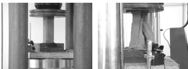
Figura 5. Ensaio de compressão no tijolo, com carga aplicada na direcção paralela aos furos.
