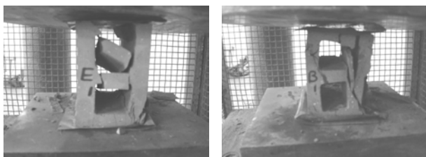
Figura 6. Ensaio de compressão no tijolo, com carga aplicada na direcção perpendicular aos furos.
