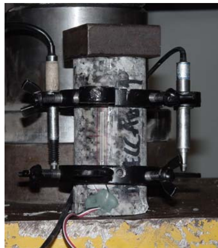
Figura 2 – Foto do ensaio em provetes de granito
