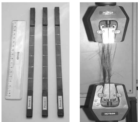
Fig. 8 – Caracterização experimental do comportamento à tracção dos laminados de CFRP
