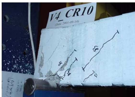
Fig. 17 – Modos de rotura típicos nas vigas da série CR
