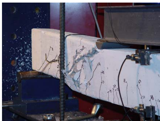
Fig. 12 – Modo de rotura ocorrido na viga V2_PR10
